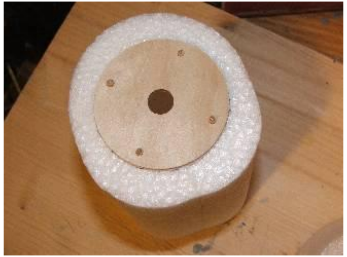
Přilepit motorovou přepážku. Vyříznout otvor pro kabely motoru.
