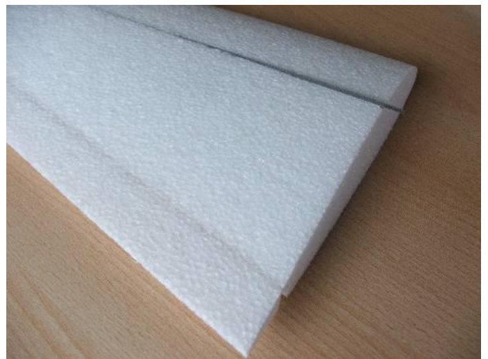
Ostrým nožem vyříznout drážku a vložit uhlíkový pásek. Pásek musí přesahovat ve středu křídla asi 10 mm.
