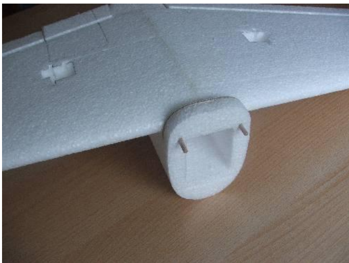
Křídlo nasadit na střední díl trupu a vyznačit otvory pro kolíky křídla.
